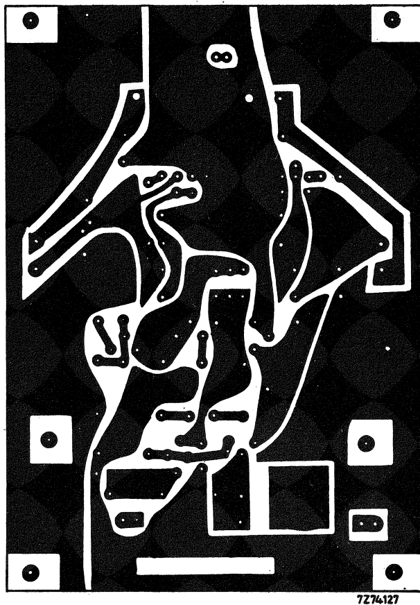
Fig. 5 - Circuito stampato tipo B per la realizzazione degli amplificatori 3, 4, 5, visto dalla parte del rame.
